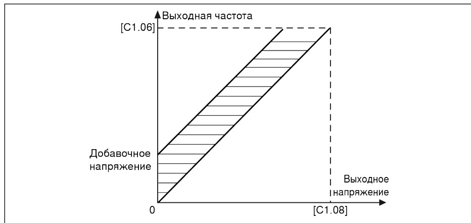
Рис. 12-69: Автоматическое повышение крутящего момента с линейной кривой V/F
