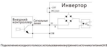
Подключение исходного полюса с использованием внутреннего источника питания 24 В
